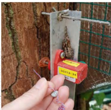
Le dendromètre est un capteur qui mesure les variations de diamètre du tronc ou d'une branche d'un arbre. Il permet également d'étudier la capacité de l'arbre à se recharger en eau.
